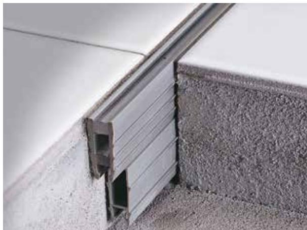
Giunto di frazionamento modulare per posa a malta in materiale sintetico. Ideato per frazionare aree piastrellate di grandi dimensioni in zone più piccole. L'utilizzo delle relative prolunghe ad incastro -una o più- consente il raggiungimento di altezze importanti. Offre una limitata protezione al bordo del rivestimento e compensa piccoli movimenti dovuti alla dilatazione dei materiali di supporto, ma esclusivamente in compressione o scorrimento.
